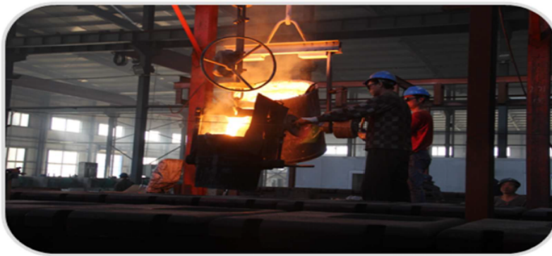
FIGURE 4.5 – L'opération de moulage de vannes dans une usine de fonderie.
